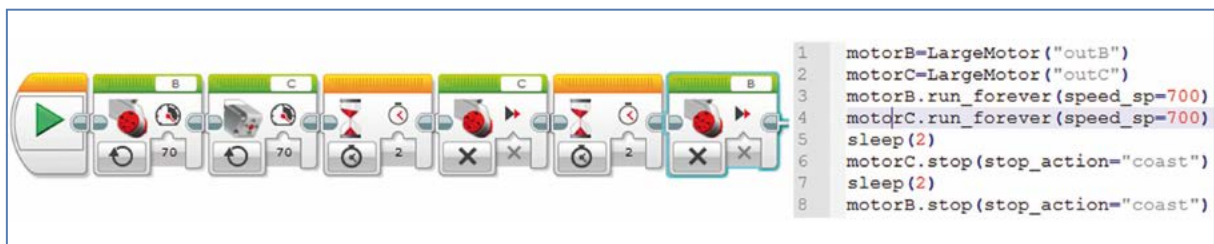
Abbildung 4: gleiches Resultat in unterschiedlichen Sprachen: EV3-Software (grafisch) und Python; ein schwieriges Ziel ist das Übersetzen von der einen in die andere Richtung (eigene Screenshots, 2018)
